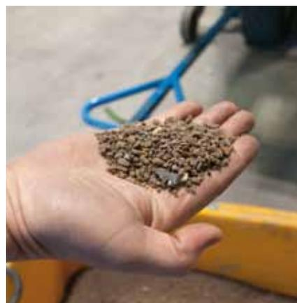
**Bild 2:** Nur noch 10 % Ausschuss pro Tonne, der durch Neusand ersetzt werden muss, fallen nach der Regenerierung an.
