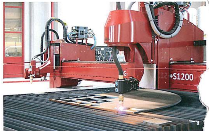
Die Plasmaschneidanlage arbeitet mit hoher Schnitt- und Lochqualität. Bilder: Teka/Microstep
