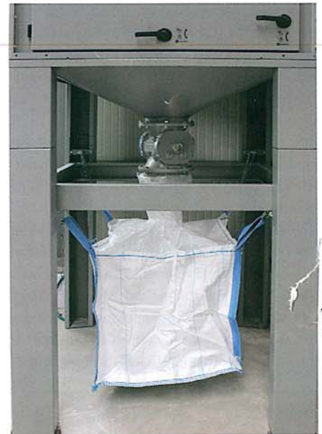
Die Zellenradschleuse befördert die Partikel kontinuierlich in das Big-Bag.
