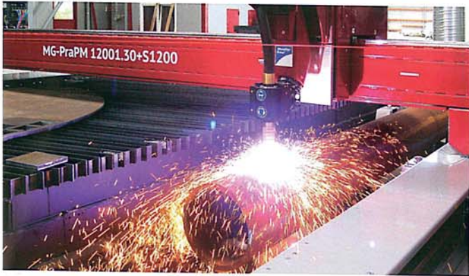
Das 3D-Bearbeiten von Rohren und Profilen zählt zum Aufgabenspektrum der multifunktionalen Schneidanlage.
